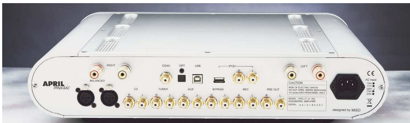
Sul pannello posteriore spiccano le placchature in oro di tutti i connettori, inclusi i morsetti di collegamento dei diffusori. In basso troviamo i connettori relativi ai segnali analogici, inclusi quelli per l'ingresso bilanciato. In alto sono invece collocati i connettori per i segnali digitali, tra cui la porta USB per il collegamento al computer.
